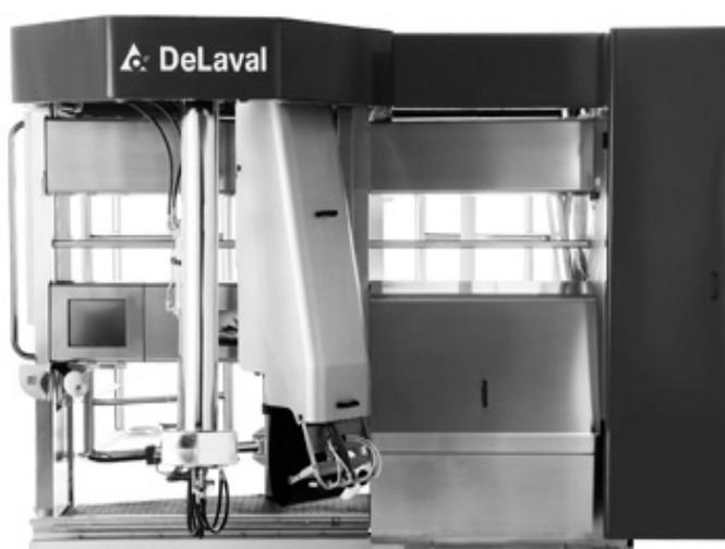
Рисунок 59 – Робот-дояр компании «Делаваль»
