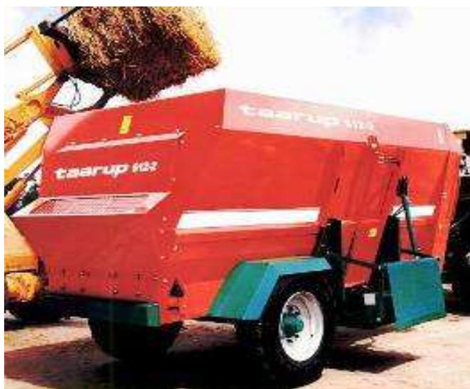
Рисунок 73 – Прицепной миксер с горизонтально расположенными доизмельчающими и перемешивающими шнеками
