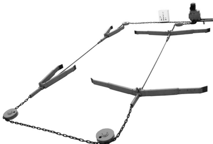
Рисунок 47 – Принципиальная схема скреперной установки
