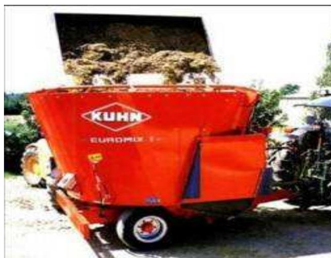
Рисунок 74 – Прицепной миксер с вертикально расположенными перемешивающими шнеками
