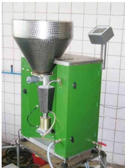
Рисунок 4 – Установка автоматизированная для выпойки телят УАВТ-60
