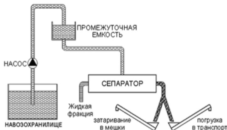
Рисунок 48 – Схема работы сепаратора
